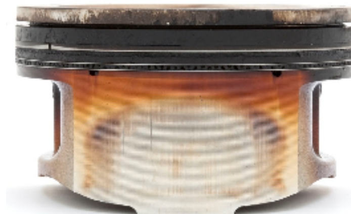
Неэффективная защита от отложений
