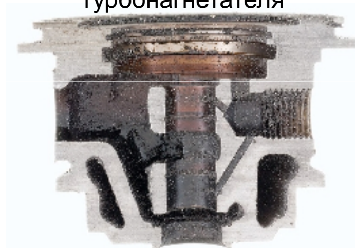
Неэффективная защита турбоагнетателя
